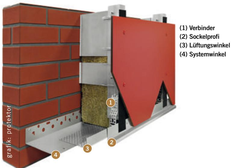
Der Verbinder gewährleistet die DIN-konforme Umsetzung. Mit dem System- und Lüftungswinkel können unterschiedliche Wandaufbauten und Bauwerkstoleranzen ausgeglichen werden.
